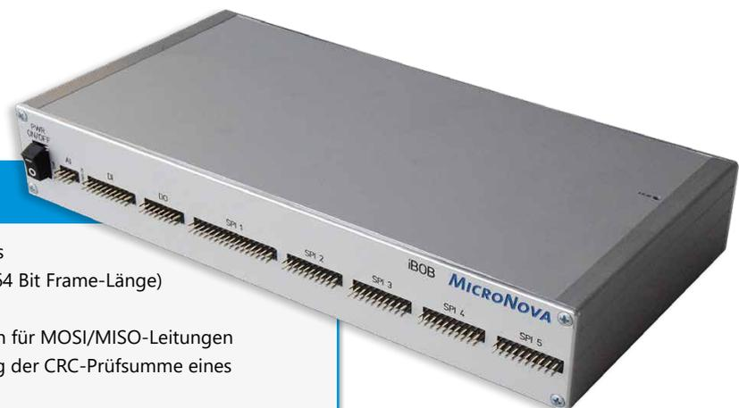
**1** Die iBOB ermöglicht es, die Kommunikation zwischen zwei unabhängigen, über einen SPI-Bus verbundenen Mikrocontrollern zu testen.
